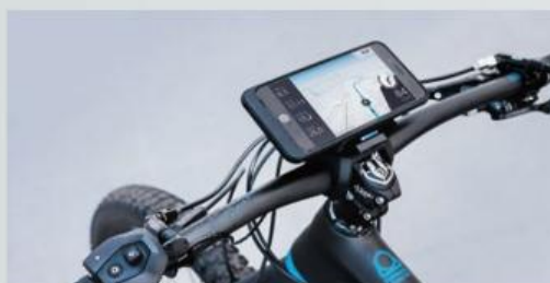
Steuerung per Bosch Bedieneinheit Control via Bosch control unit
